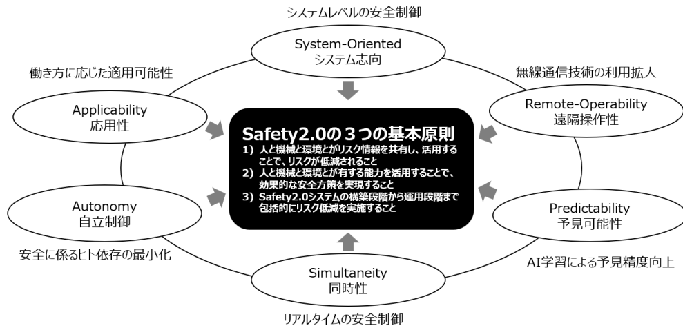
図 1 Safety 2.0 構築に共通的に適用可能な ICT 特性の事例
